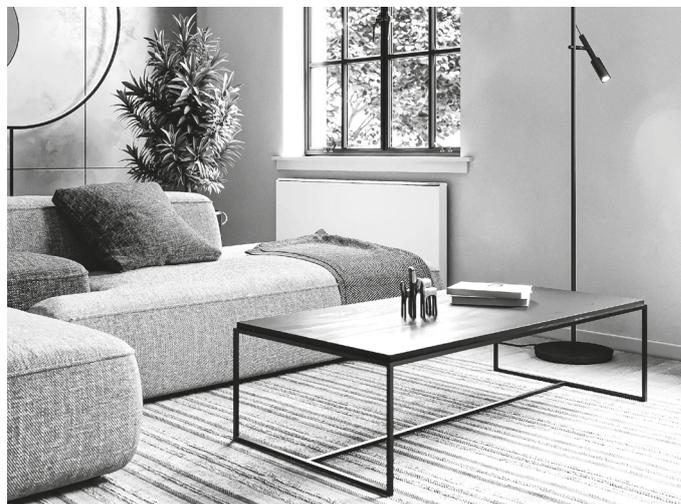
Tieftemperaturheizkörper kommen schon mit 35 Grad Vorlauftemperatur aus und sind bei gleicher Größe deutlich effizienter als herkömmliche Geräte. *Foto: djd/www.jaga.com*
